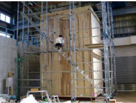
図5：床衝撃音遮断性能試験の実験棟
