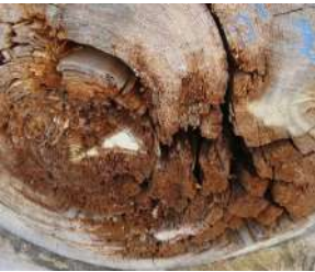
図1：木材の腐朽
