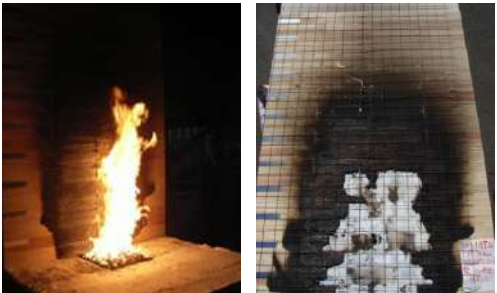
図1：壁の燃焼試験（試験開始480秒後）
