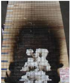
図2：壁の燃焼試験（試験終了後の試験体）
