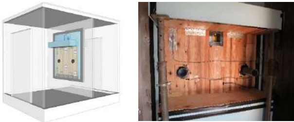
図11：高知県立森林技術センターでの結露試験
