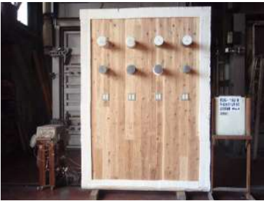
図2：120分のCLTの加熱試験
