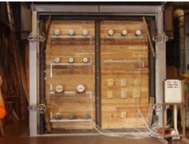
図1：75分のCLTの加熱試験
